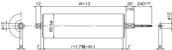
■ モーターローラ寸法図 ※高トルクの場合は( )内寸法となります。
